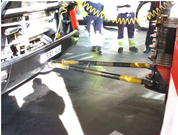
Imagen 5: Lanza doble de remolque y enganche
